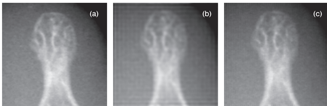
図4 X線グリッドを使用しないで撮影した画像とフィルタ処理後画像との比較 (グリッド密度: 40 lines/cm)
